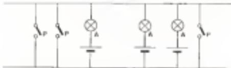
Figura 4. La periferica e il controller collegati sul Bus HP-IB possono essere accendibili o sbracciati in seguito da software di periferica e di lampadine in serie ad una busbar. Le lampadine si accendono la funzione di accendere. Quando uno o più degli indicatori sono chiusi, lo stato logico della linea è 1. Se tutti gli indicatori sono aperti, lo stato logico della linea è 0. Nella pratica gli indicatori sono circuiti da transistor a Bus driver e le lampadine da porta a "verone".
